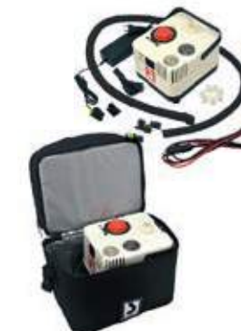
24.065 ΤΡΟΜΠΑ ΗΛΕΚΤΡΙΚΗ BRAVO 12 • 12V • ΜΕ ΡΥΘΜΙΣΤΗ ΠΙΕΣΕΩΣ • ΕΩΣ 1500 MBAR /22,5 PSI • ΠΑΡΟΧΗ ΑΕΡΑ 150LT/MIN
