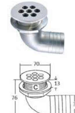
10.356 ΥΔΡΟΡΡΟΗ ΑΠΟΧΕΤΕΥΣΗΣ ΣΤΕΝΗ ΙΝΟΧ ΓΩΝΙΑΚΗ 90° ΓΙΑ ΣΩΛΗΝΑ 38mm
