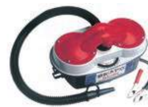
24.061 ΤΡΟΜΠΑ ΗΛΕΚΤΡΙΚΗ BRAVO 12 • 12V • ΜΕ ΡΥΘΜΙΣΤΗ ΠΙΕΣΕΩΣ • ΕΩΣ 300 MBAR /4,4 PSI • ΠΑΡΟΧΗ ΑΕΡΑ 150LT/MIN
