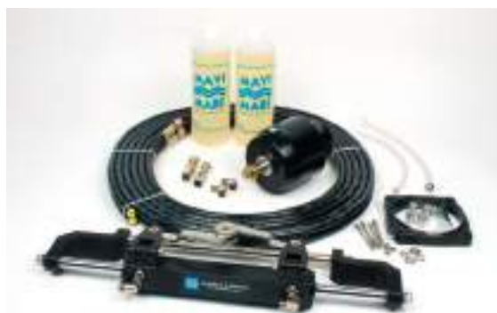
81.202 - ΥΔΡΑΥΛ. ΣΥΣΤΗΜΑ ΤΙΜΟΝΙΟΥ ΕΩΣ 300HP • ΣΤΡΟΦΕΣ 5,2 • 2 ΣΩΛΗΝΕΣ 5/16" / 7,5 ΜΕΤΡΑ
