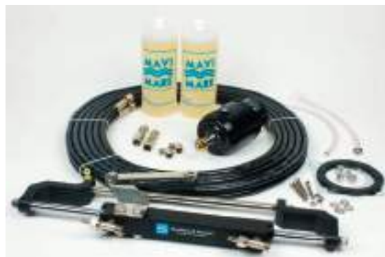
81.201 - ΥΔΡΑΥΛ. ΣΥΣΤΗΜΑ ΤΙΜΟΝΙΟΥ ΕΩΣ 150HP • ΣΤΡΟΦΕΣ 4,9 • 2 ΣΩΛΗΝΕΣ 1/4" / 6 ΜΕΤΡΑ
