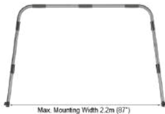
ΡΟΛ ΜΠΑΡ ΓΙΑ ΠΟΛΥΕΣΤΕΡΙΚΟ ΣΚΑΦΟΣ 90.029 Φ30mm L162-210cm 90.031 Φ40mm L162-210cm 90.033A Φ50mm L162-210cm 90.033B Φ50mm L205-240cm
