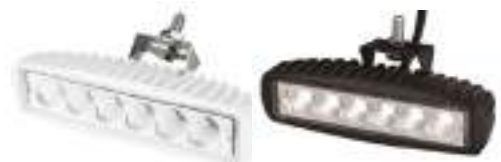
ΠΡΟΒΟΛΕΑΣ ΣΤΕΝΟΣ SPOT ΦΩΤΙΣΜΟΣ 1200LM 9-60V 6x3W 15.279A ΛΕΥΚΟΣ 15.279B ΜΑΥΡΟΣ
