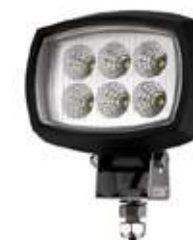
15.256 ΠΡΟΒΟΛΕΑΣ 6x3W LED ΑΔΙΑΒΡΟΧΟΣ IP66 560LM 9-56V
