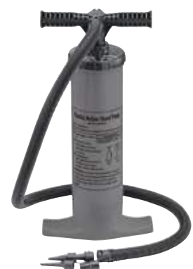
24.614 ΤΡΟΜΠΑ ΧΕΙΡΟΚΙΝΗΤΗ BRAVO 4 SH • 500mbar/7,2 PSI • ΔΙΠΛΗΣ ΕΝΕΡΓΕΙΑΣ • ΧΩΡΗΤΙΚΟΤΗΤΑ 2x2000cc
