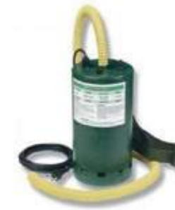
24.612 ΤΡΟΜΠΑ ΗΛΕΚΤΡΙΚΗ • 230V • ΕΩΣ 230 MBAR/3.3 PSI • ΠΑΡΟΧΗ ΑΕΡΑ 1500LT/MIN
